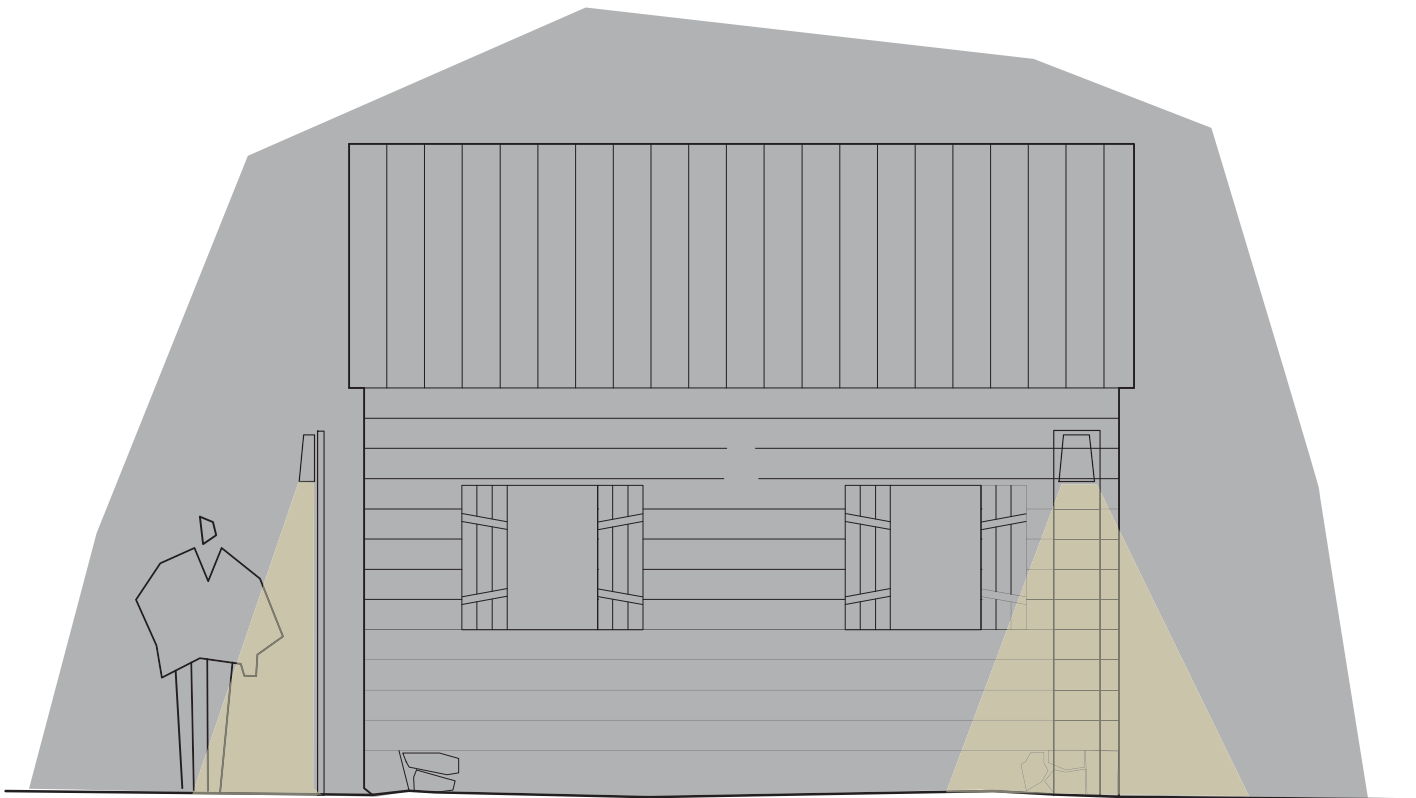
Belysningsprincip för kyrkstugskvarter med armatur fäst på trästolpe som placeras en bit från byggnaden.
