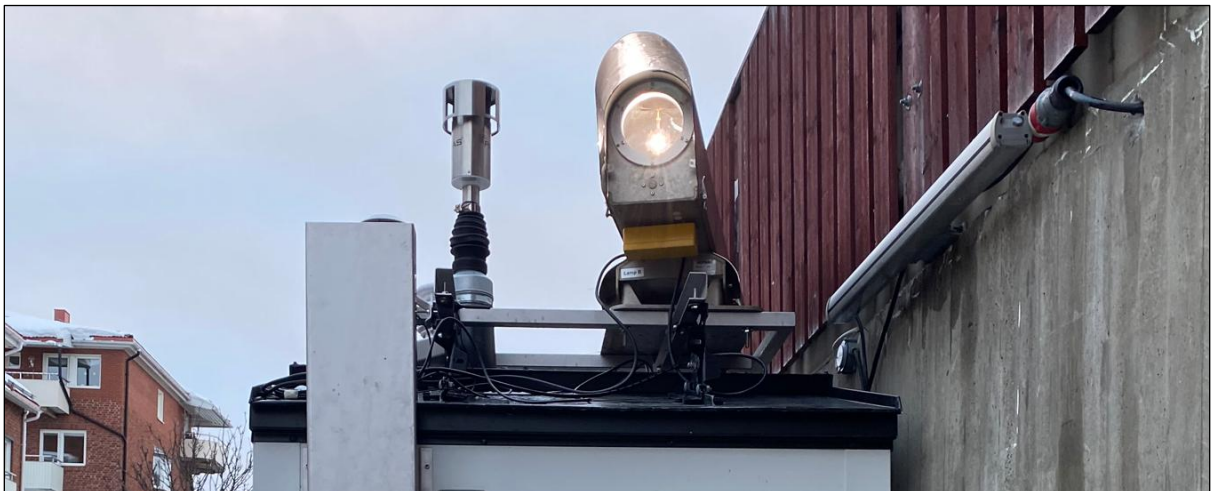
Figur 3.3. Taket på mäthuset vid Prästgårdsgatan. Cylindern till vänster är luftintaget till PM10-mätaren, ljuskällan till höger är främre delen av en kombinerad ljussändare och -mottagare med vars hjälp NO 2 -halterna mäts.
