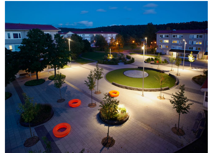
På torget monteras fyra 12m höga koniska stolpar. På dessa monteras LED strålkastare som belyser torgytan. Genom möjligheten att styra ljuset kan olika effektljussättningar uppnås beroende på evenemang. Stolpar och armaturer lackas i samma kulör. Stolparna förbereds också för fler inkopplingspunkter för ström samt extra infästning för eventbelysning vid större evenemang.
