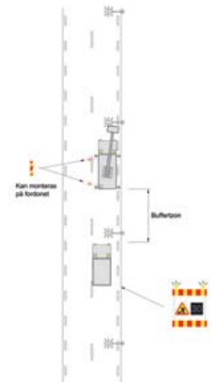
9. Arbete med lift
