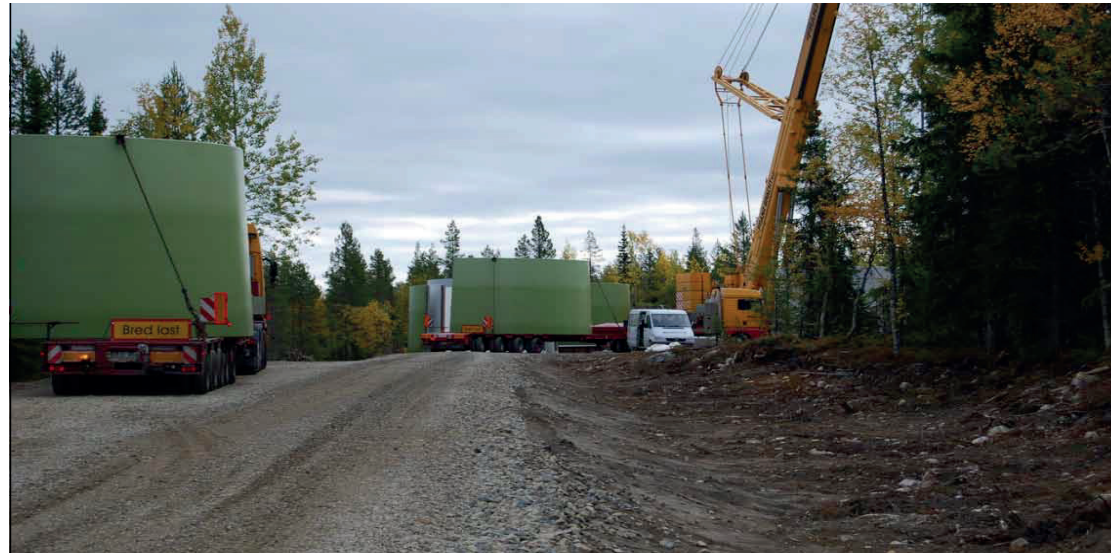
Transporterna är breda och kräver därför breda stabila vägar (foto: Jonas Lundmark).
