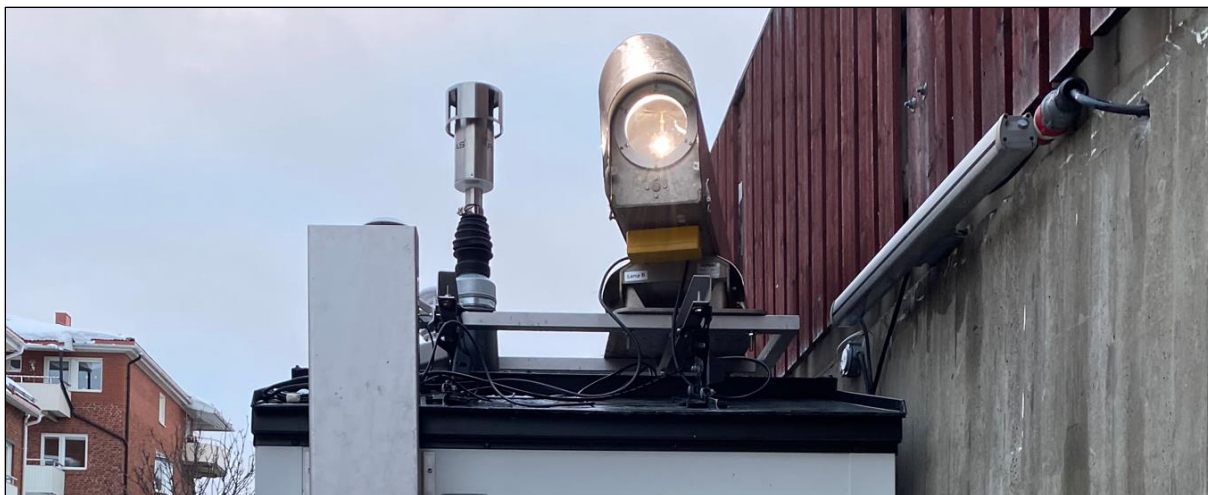
Figur 3.2. Taket på mätuset på Prästgårdsgatan. Cylindern till vänster är luftintaget till PM10-mätaren, ljuskällan till höger är främre delen av en kombinerad ljussändare och -mottagare med vars hjälp NO 2 -halterna mäts. Se även bild på omslaget.
